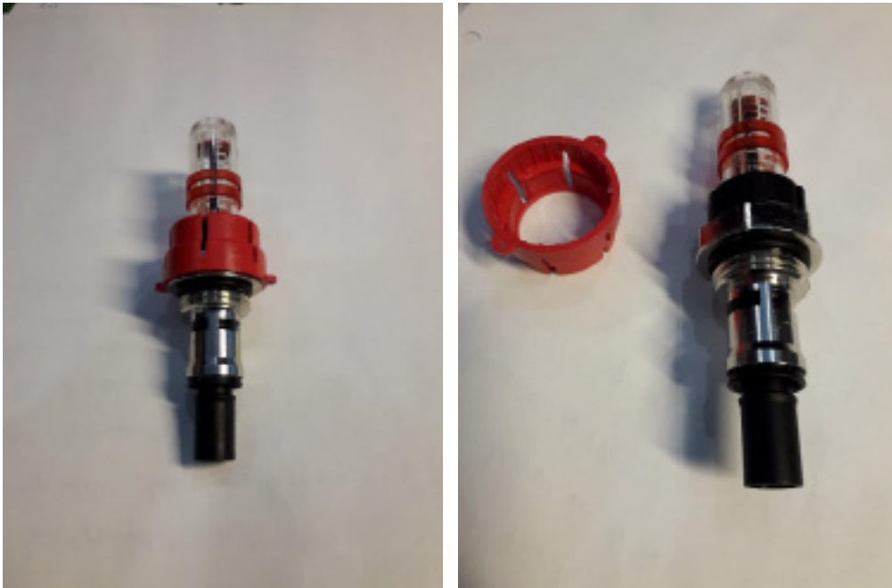
Kuva 1. Irroita virtausmittarin punainen lukituskappale. Kuva 2. Lukituskappale irroitettuna
