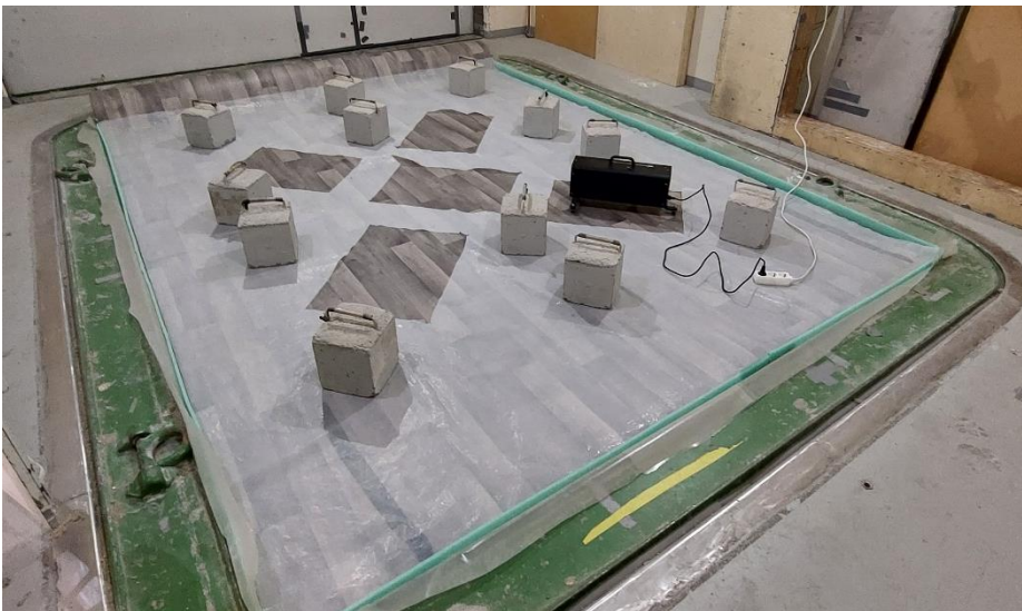
Kuva 2. Muovimatto asennettuna ja kuormitus painot.
