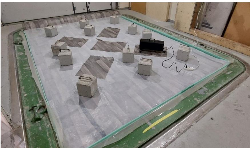
Kuva 3. Muovimatto asennettuna ja kuormitus painot.
